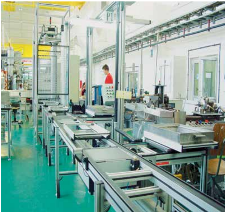
Linie de transfer inter-operațional Proiectare și execuție EAST ELECTRIC
